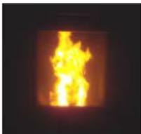
Combustion CORRECTE, flamme vive jaune/blanche avec une quantité minimum de granulés dans le brasier. Combustion idéale qui ne nécessite aucune modification. La figure montre une flamme produite par le poêle avec une puissance de fonctionnement programmée sur une valeur maximum de 5.
