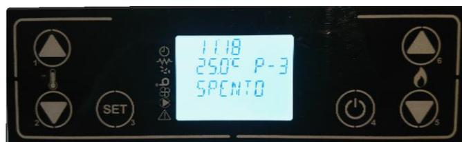
Les significations des indicateurs d'état sur le côté gauche de l'afficheur sont indiquées ci-dessous. L'activation, à l'écran, d'un des segments dans la zone « ÉTAT » indique l'activation du dispositif correspondant en fonction de la liste en dessous.
