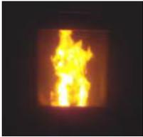
Combustion CORRECTE, flamme vive jaune/blanche avec une quantité minimum de granulés dans le brasier.
