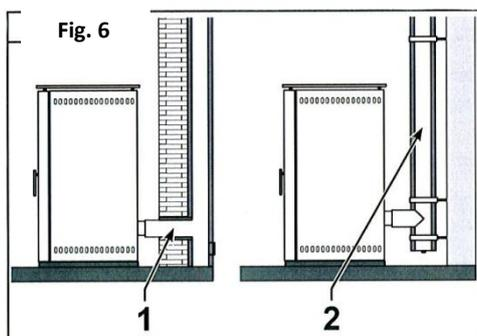
Comme alternative nous conseillons l'utilisation d'un tuyau industriel isolé qui peut être utilisé aussi à l'extérieur pour éviter la formation d'eau de condensation.
