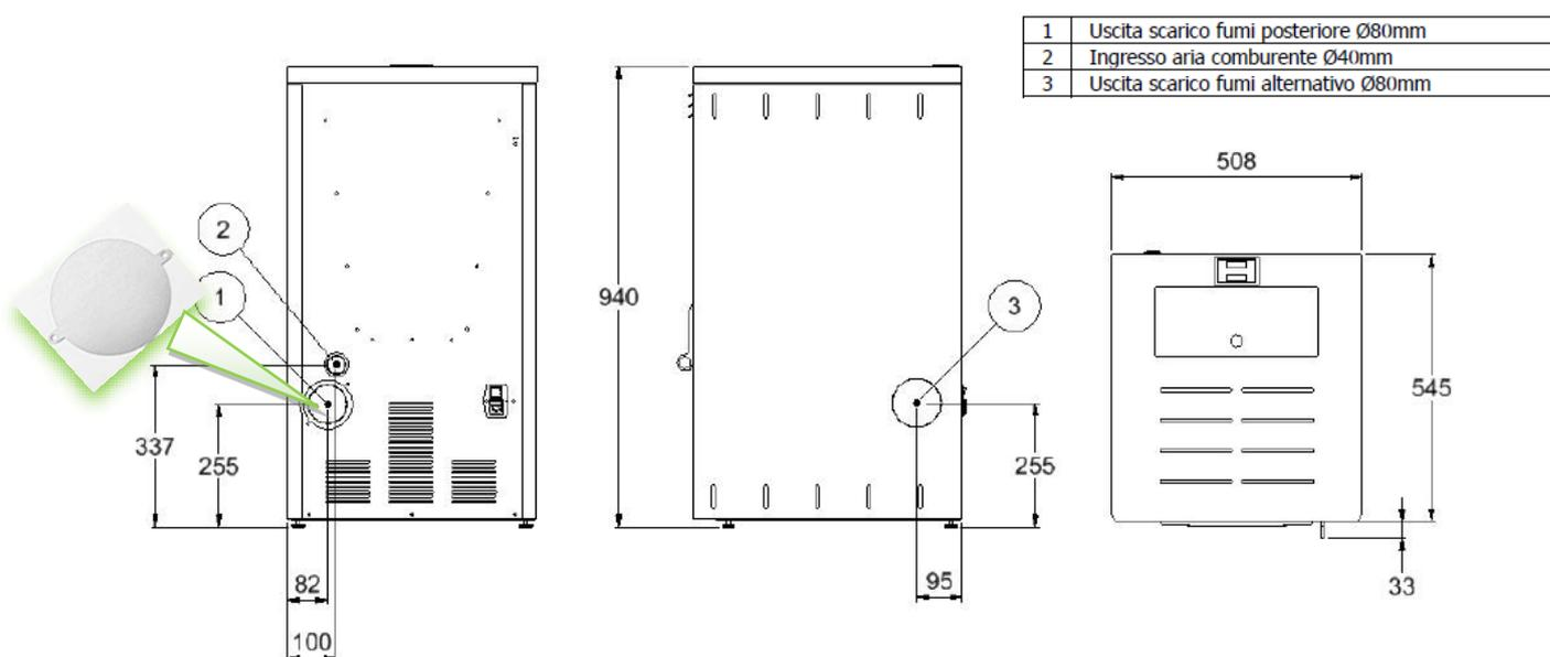
**ATTENTION: Fermez la sortie arrière avec son couvercle si vous utilisez la sortie sur le côté DX**
