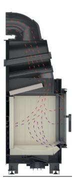
Le réglage de l'insert s'effectue par l'intermédiaire d'un mécanisme unique (contrôleur de position du papillon des gaz) en dessous de la porte de l'insert.
